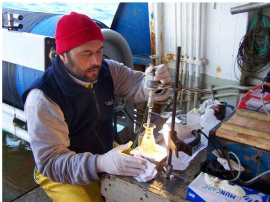
**Medición de concentración oxígeno (O<sub>2</sub>) en muestra de agua de mar.**
