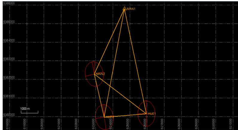
Imagen N°9, Esquema apoyo geodésico sector Hueihue.
