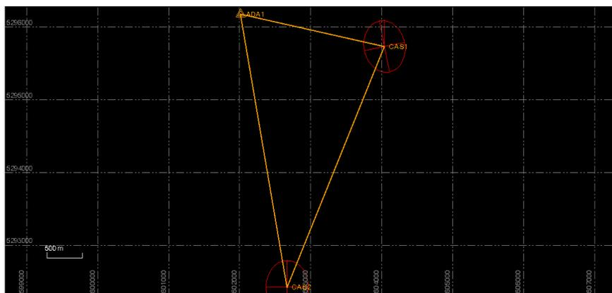
Imagen N°16, Esquema apoyo geodésico sector Estero Castro.
