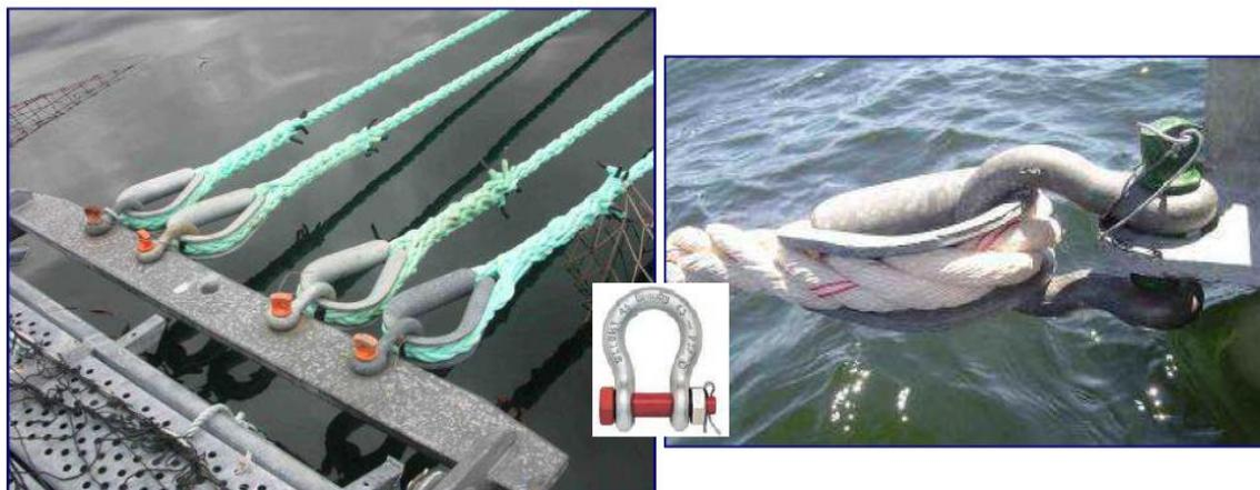
Figura 9 - Grilletes y guardacabos de las balsas jaulas metálicas cuadradas, Navtec 2011
