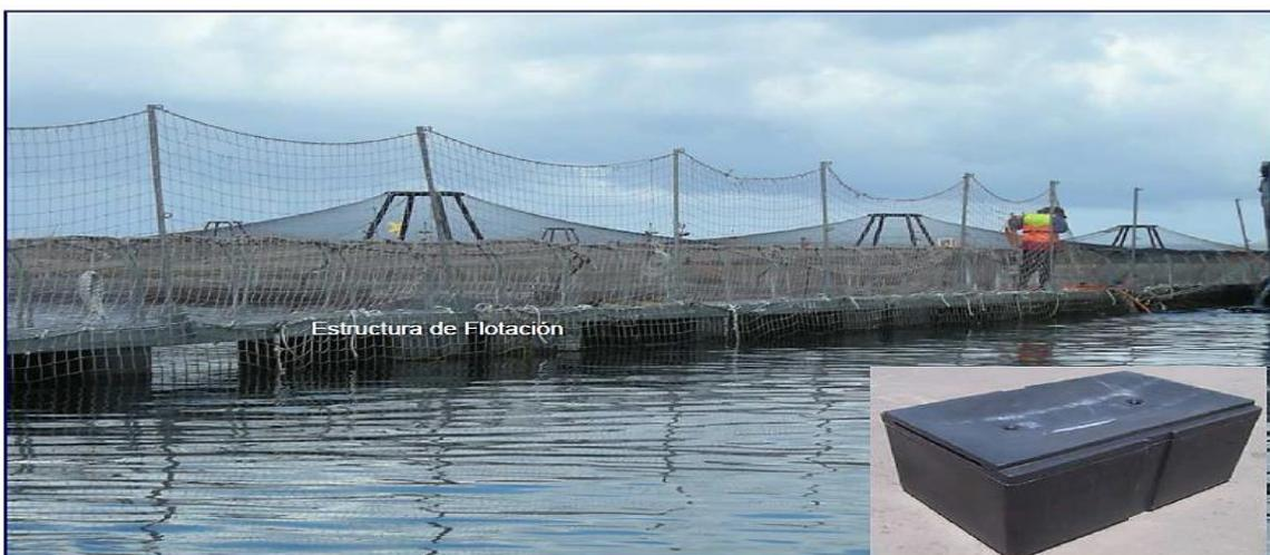
Figura 8 - Estructura de flotación de balsas jaulas metálicas cuadradas, Navtec 2011.
