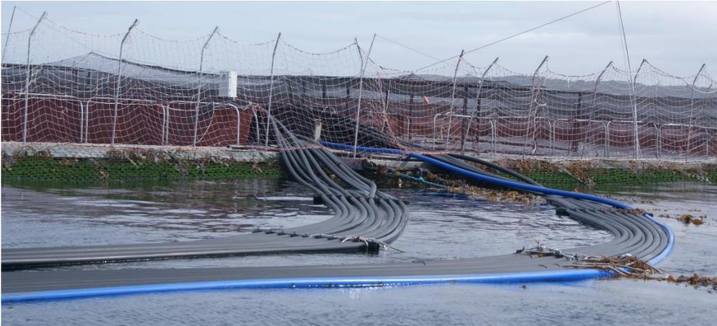
Figura 27 - Fotografía de pesos sobre balsas jaulas, cerco perimetral y mangueras de alimentación.
