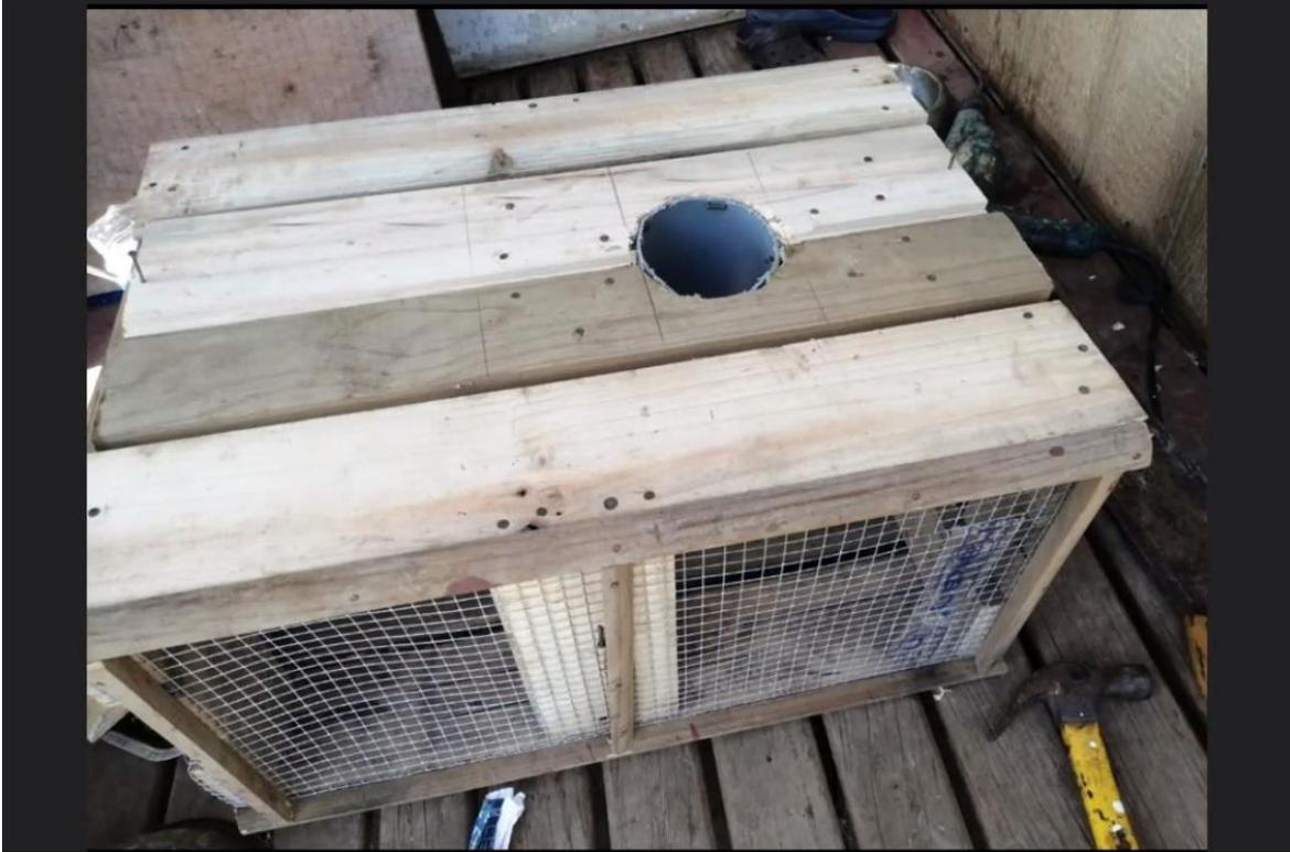
La trampa de madera con malla galvanizada es más barata y se degrada, oxidándose y desintegrándose, pero no es de plástico y no se degrada dejando micro plástico (residuos).
