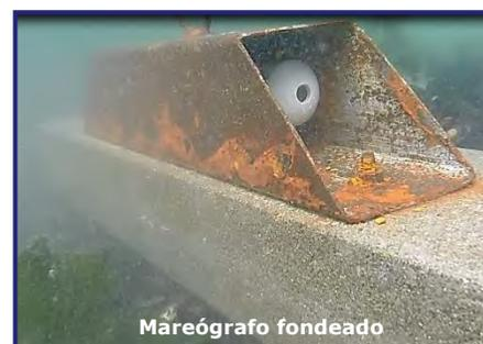
**Figura 13: Sensor de nivel del mar, marca HOBO, instalado en el fondo marino.**
