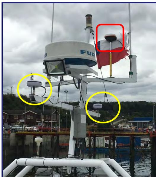
**Figura 5: Antenas del sensor de rumbo o Gyro (círculos amarillos) y DGPS (recuadro) sobre mástil de la embarcación.**
