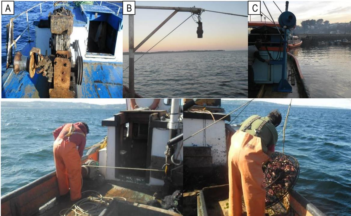
**Figura 13.** Tipos de viradores usados en la extracción de crustáceos bentónicos; **A)** Winche; **B)** pluma; **C)** Sistema hidráulico. Fotografía inferior registra la operación de virado de trampas.
