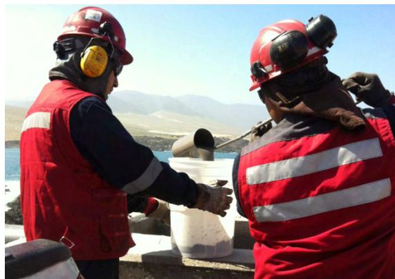
**Figura 10.** Muestreo con pala cilíndrica
