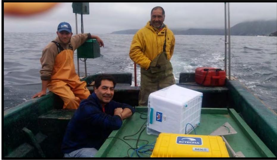
**Figura 1** Evaluación mediante ecosonda científico monohaz para macroalgas submareales (Bitecma Ltda.; EVADIR QUINTAY).
