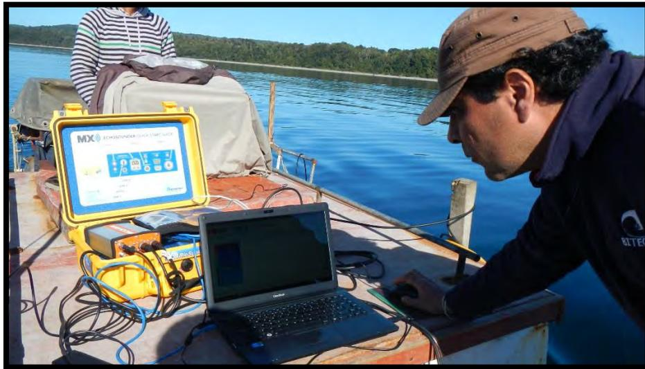
**Figura 2** Evaluación mediante ecosonda científico monohaz para macroalgas submareales en la zona de Calbuco, región de Los Lagos (Fuente Bitecma Ltda.).
