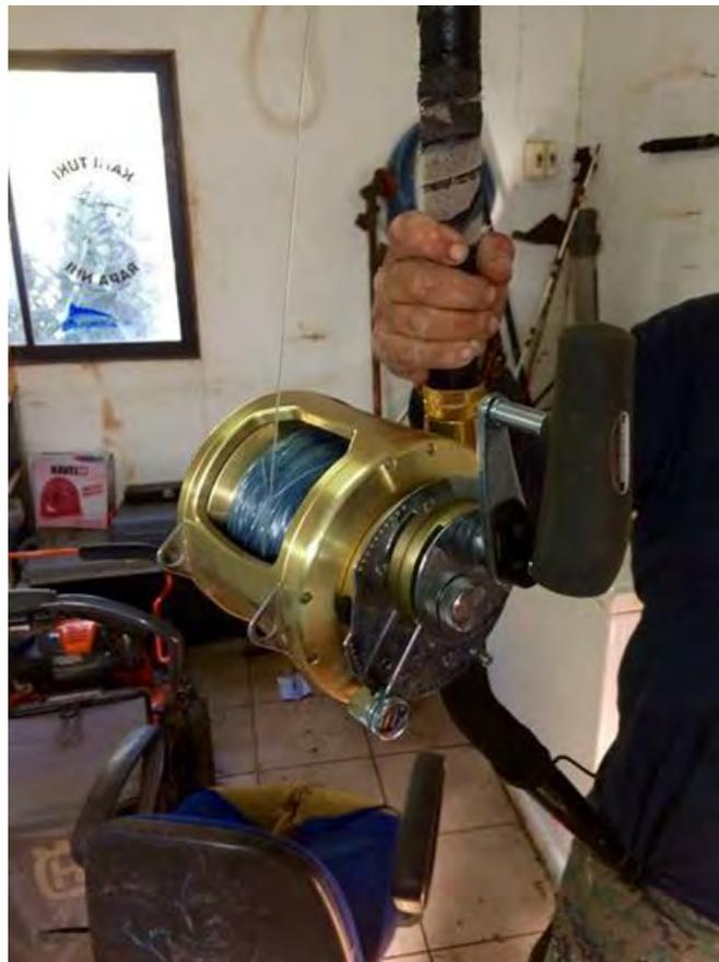
Fig. 26. Ejemplo de carrete utilizado para arrastre o trolling (específicamente en la foto un carrete Shimano Tiagra 130)
