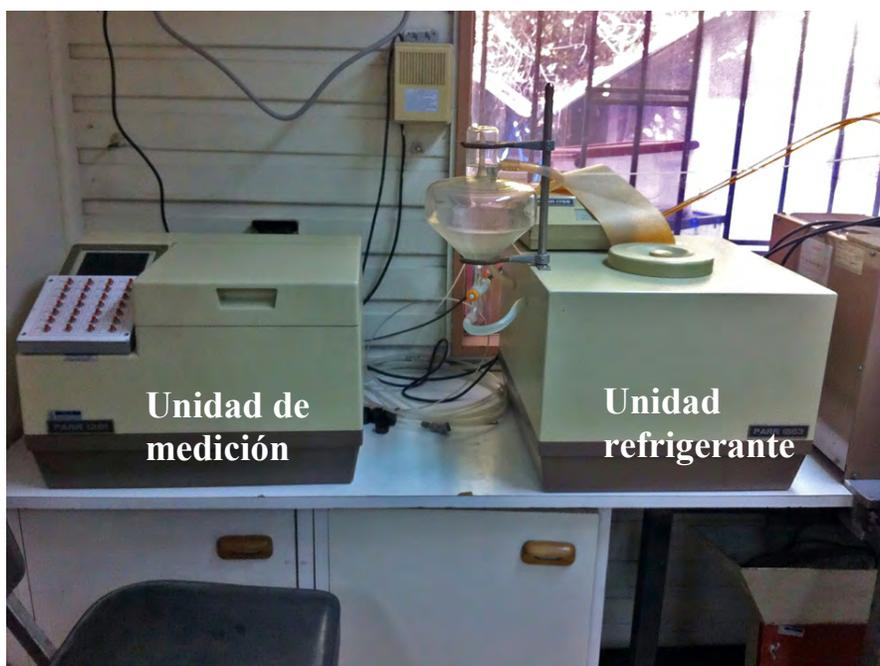
Figura 9. Fotografía de la bomba calorimétrica Parr 1261 utilizada para obtener el contenido energético de las presas de lobos marinos.
