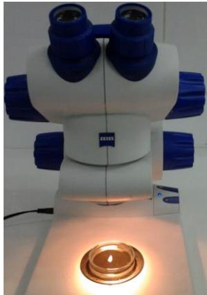
Figura 42. Estéreo microscopio Zeiss Stemi DV4 y cápsula de Petri con un otolito en su interior.
