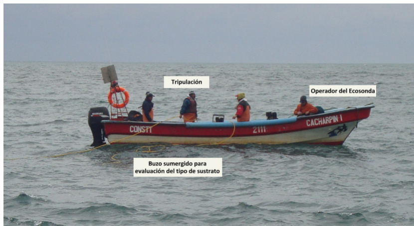
Figura 3. Esquema de trabajo general para barridos hidroacústicos.
