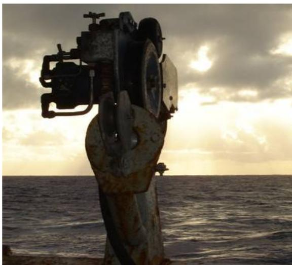
**Figura 11.** Caladora utilizada en operaciones de calado del aparejo en el PAM Tami S II.
