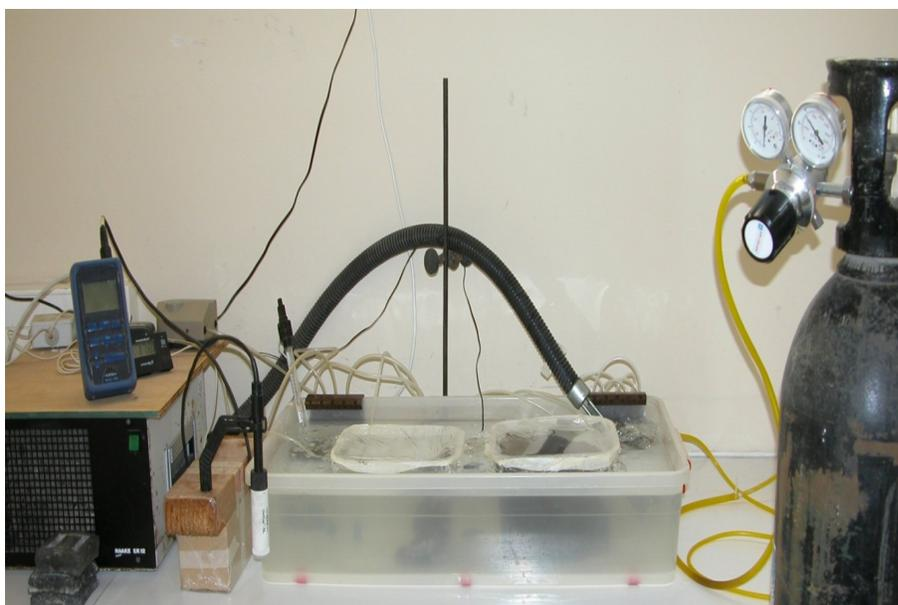
**Figura 7: Montaje experimental de hipoxia en organismos bentónicos en laboratorio.**
