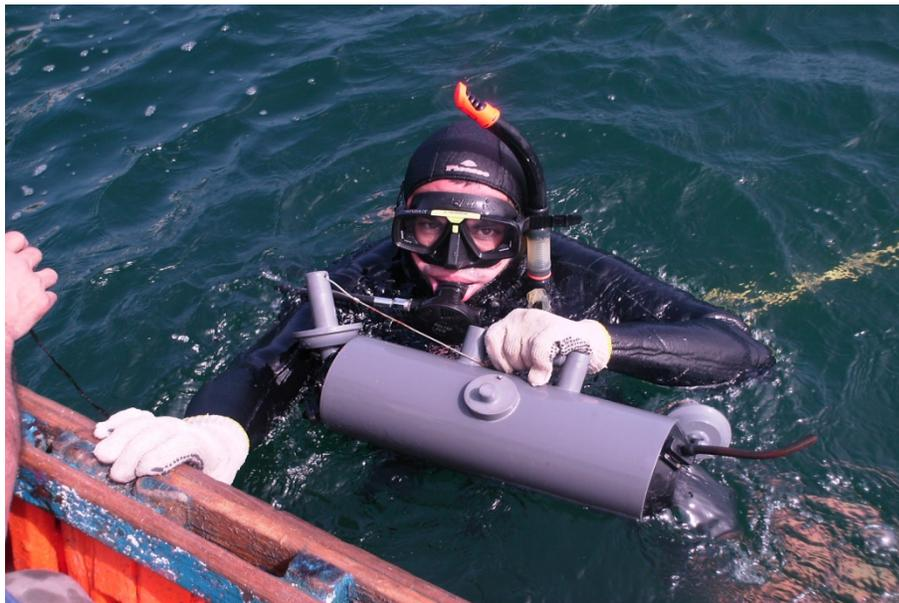
**Figura 8: Toma de muestra para la determinación de oxígeno en las áreas de manejo.**
