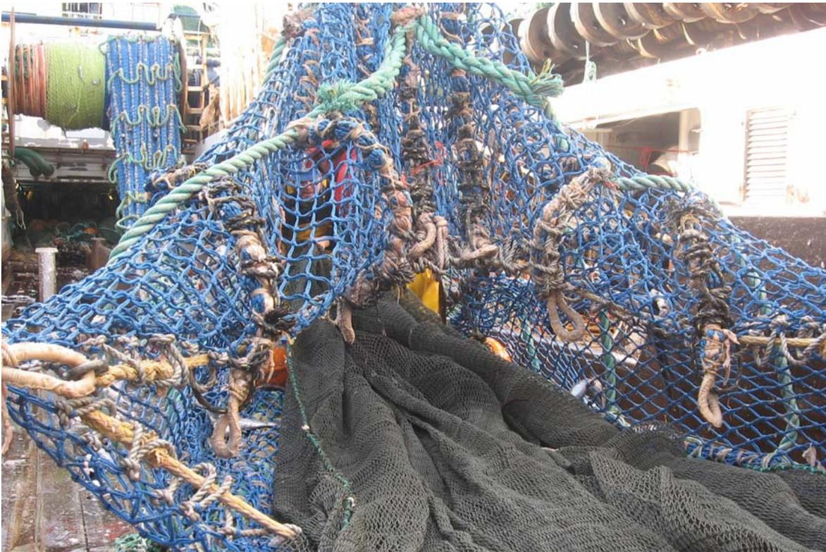
**Figura 3.** Instalaci3n cubrecopo 50 mm en red de mediagua
