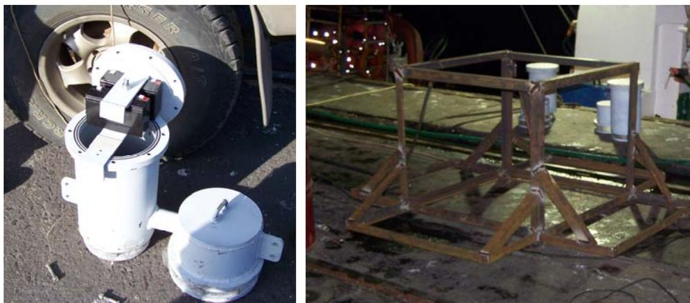
Figura 25. a) Carcaza para la cámara y flash, b) estructura de sustentación de la carcaza.
