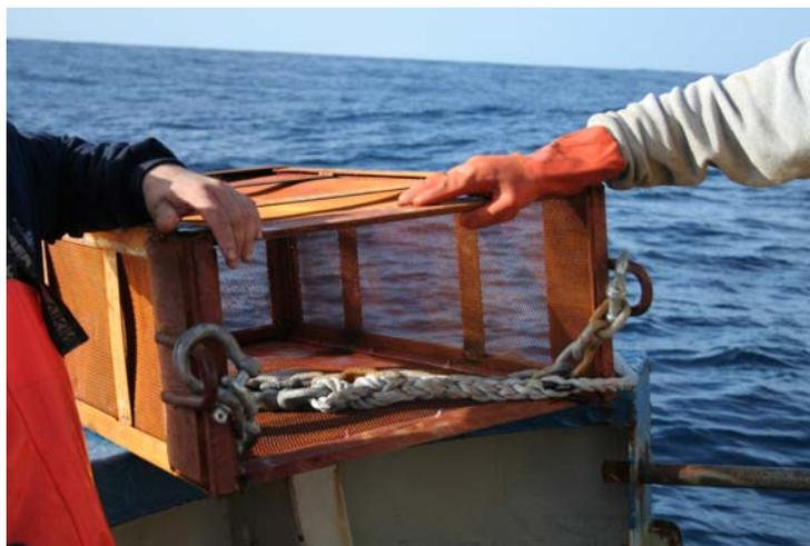
Figura 24. Rastra modelo Diego Zelaya, utilizada para el muestreo de organismos sésiles.
