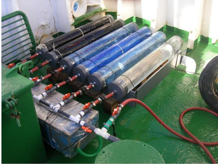
**Figura 2.4.5.** Foto de Incubadores solares *on deck* usados para incubar muestras de producción primaria.
