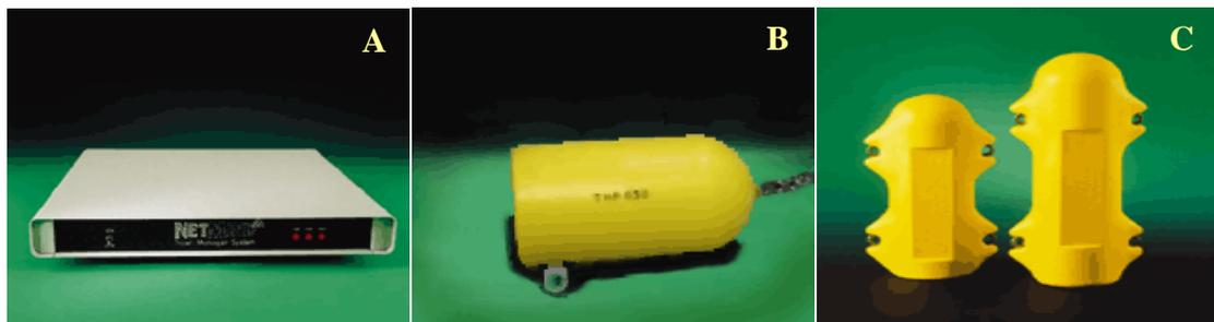
Equipo Wing Spread Netmind de North Star Technical. (A) Deck Unit de conexión entre el hidrófono y el PC; (B) hidrófono de remolque; (C) Sensores de abertura de alas.
