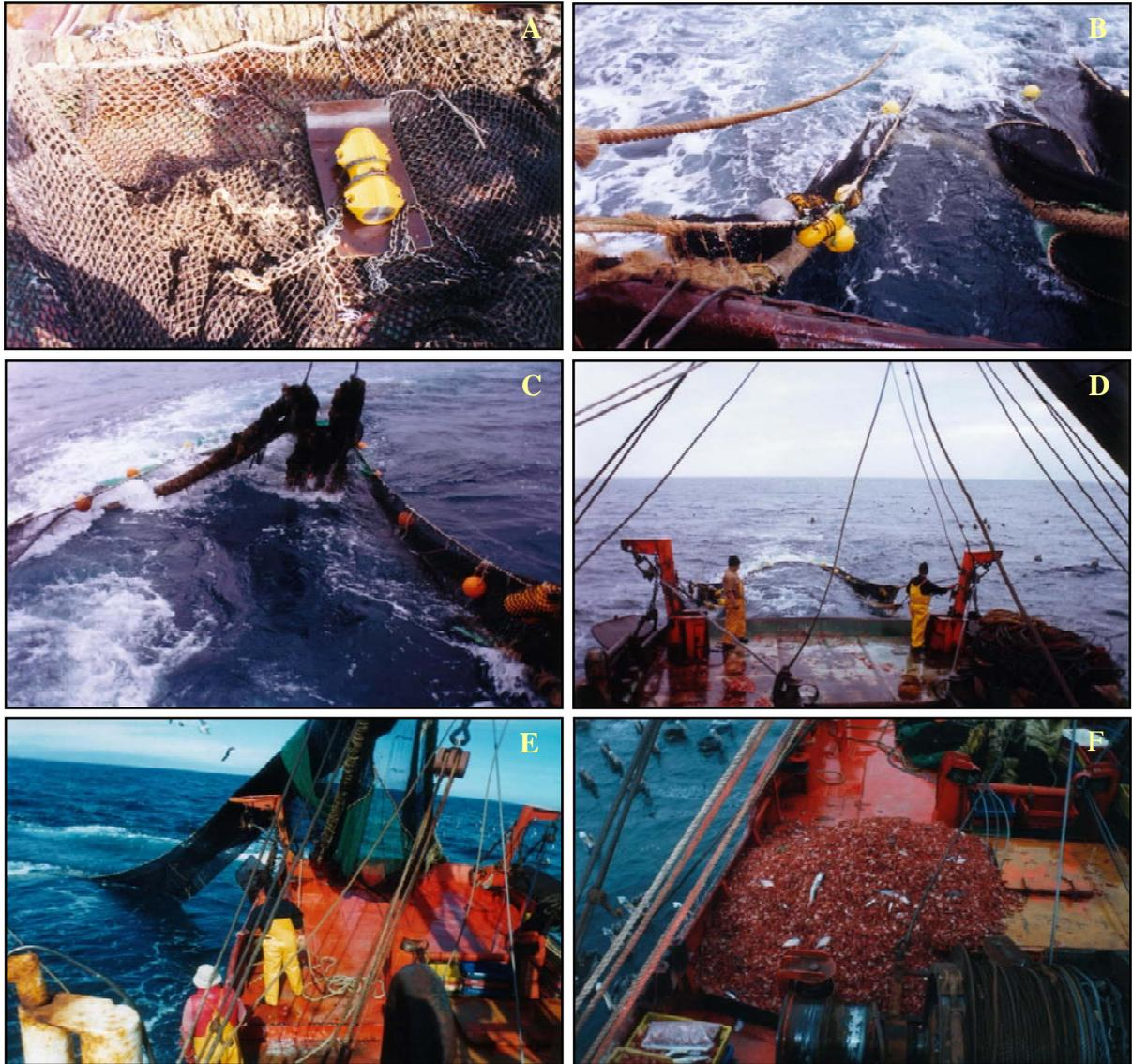
Secuencia fotográfica de la operación de pesca: (a) Instalación del sensor de ángulo, (b) ubicación del sensor Netmind (master), (c y d) Inicio del calado, (e) Inicio del virado, (f) Puesta de la captura a bordo.
