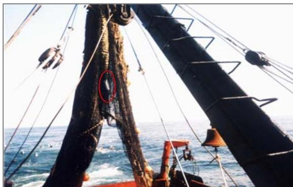
Figura 16. BCS instalado en el borlon de la red (elipse roja)
