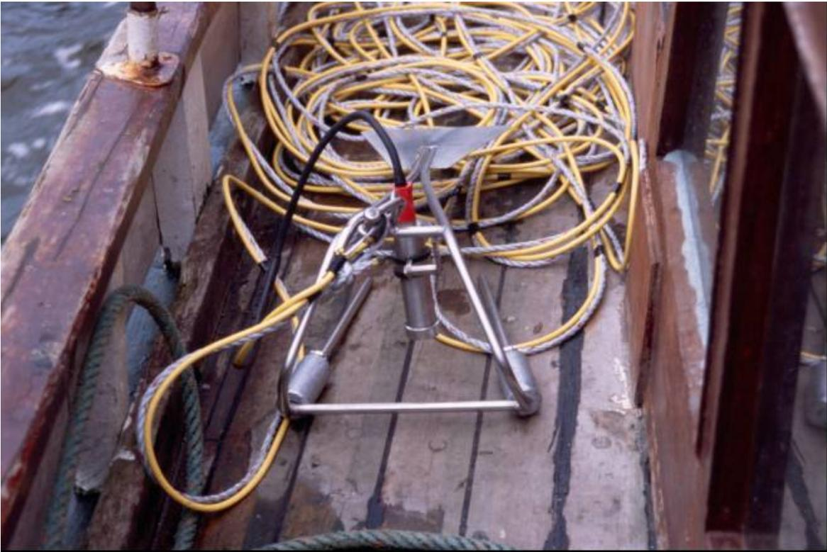
**Fotografía 2.** Cámara submarina empleada para la prospección de bancos de ostión del sur *C. vitrea*.
