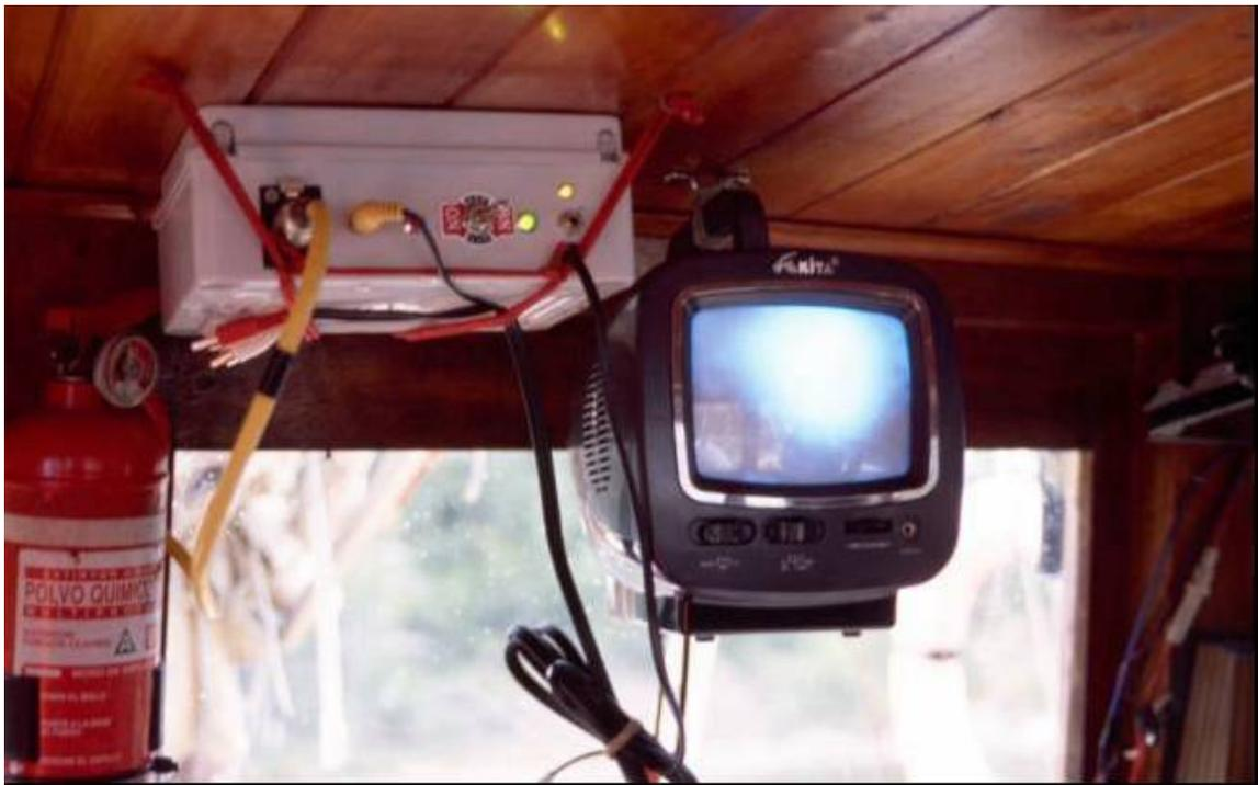
**Fotografía 4.** Monitor de la cámara submarina empleada para la prospección de bancos de ostión.
