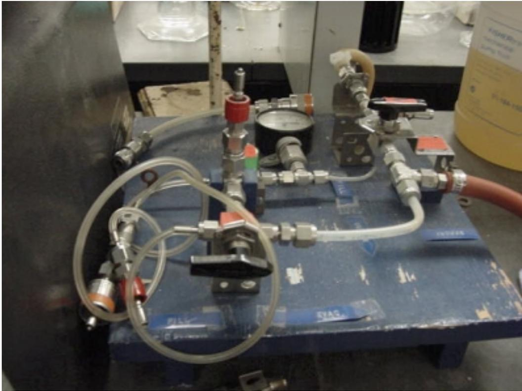
**Figura 11.** Estación de transferencia  $^{222}\text{Rn}$  a celdas de conteo.
