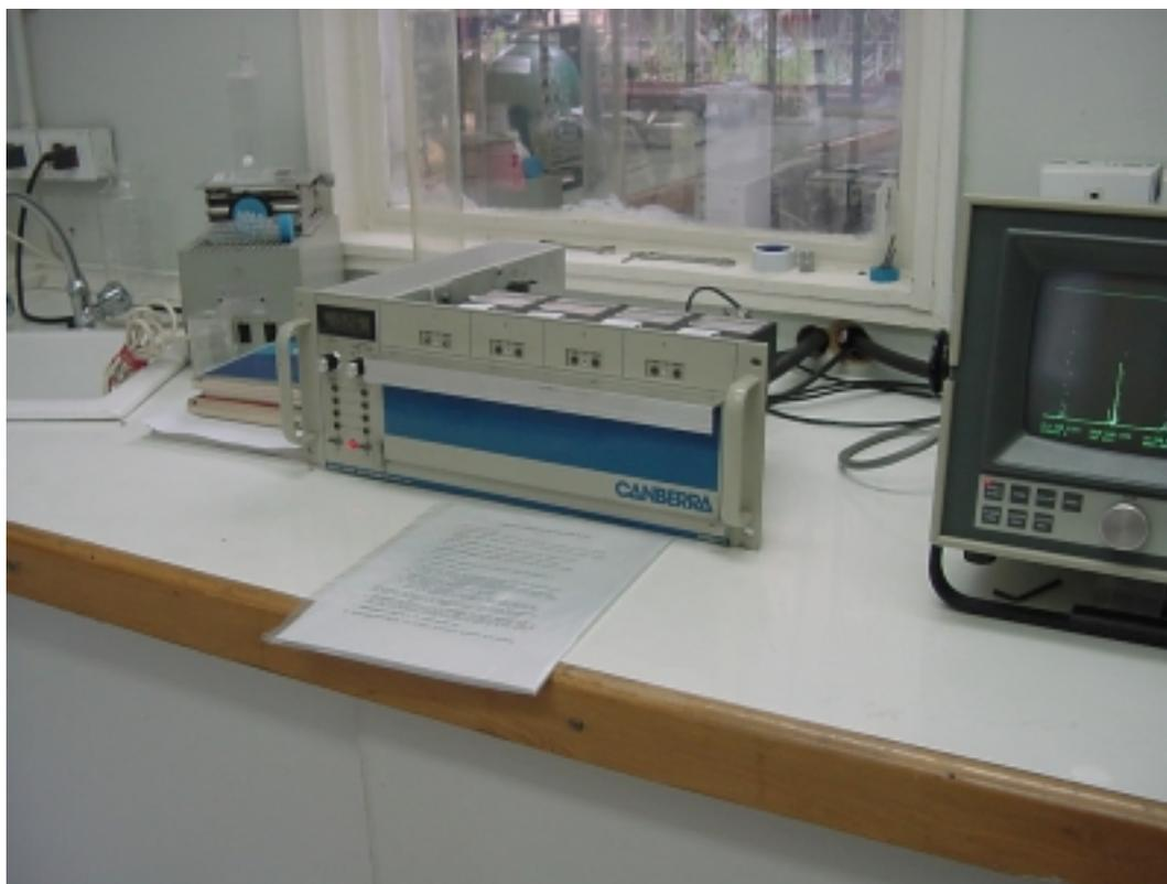
**Figura 10.** Espectrómetro Alpha utilizado para la cuantificación de  $^{210}\text{Pb}$ .
