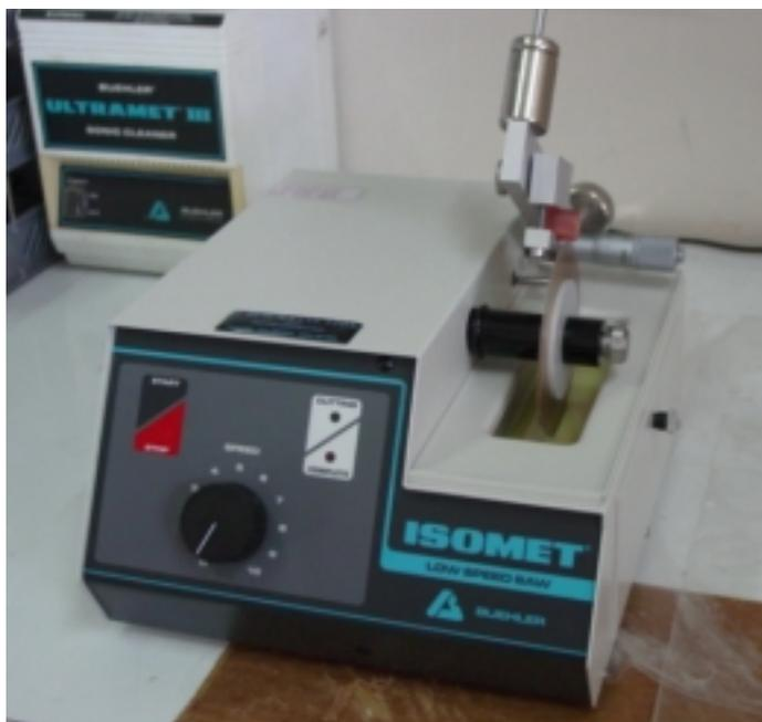
**Figura 6.** Cortadora marca Buehler modelo Isomet, permite obtener corte de los otolitos y secciones delgadas.
