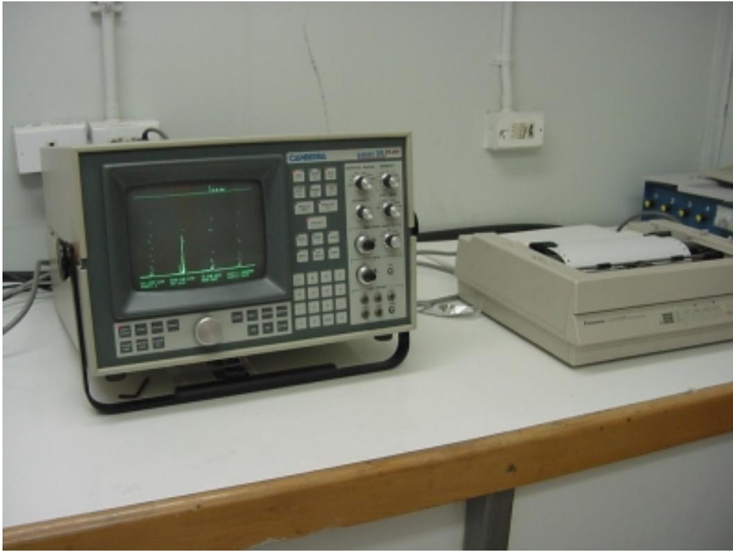
**Figura 9.** Analizador Multicanal utilizado en el conteo de  $^{210}\text{Pb}$ .
