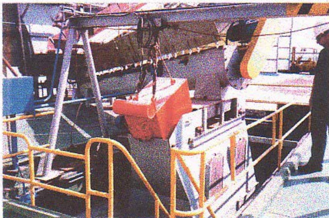
**Foto 7** Electroimán ubicado en el área de entrada a los peletizadores.
