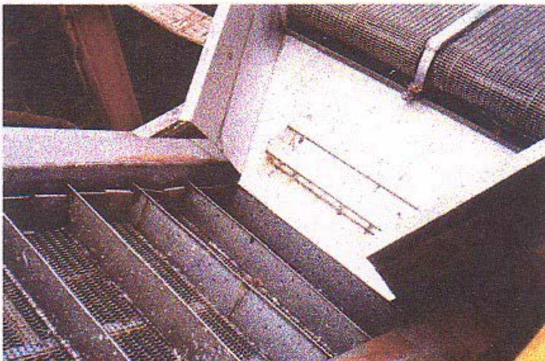
**Foto 4** Imán permanente (estandar) en área de descarga de pescado (se observan clavos y pedazos de hierro adheridas al imán).
