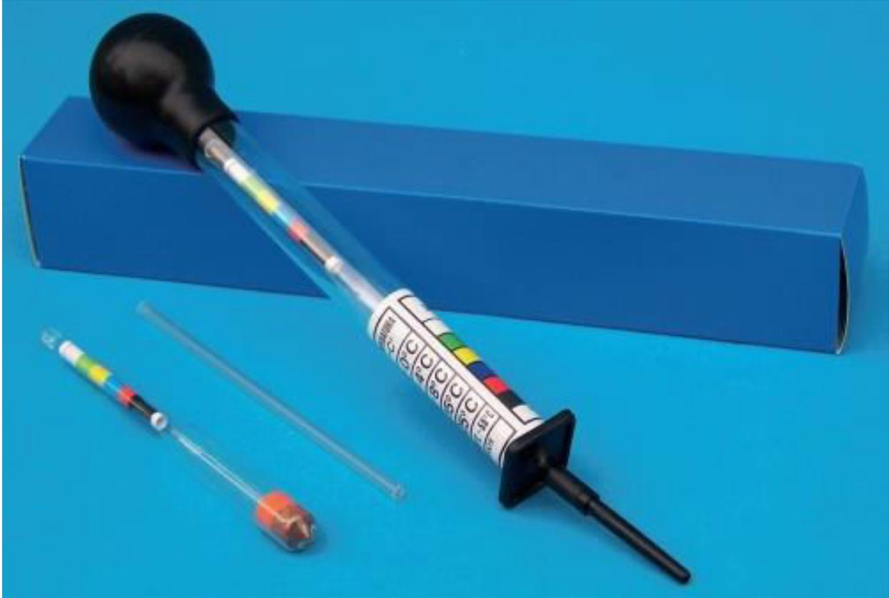
Instrumento tipo para medir salinidad y temperatura
