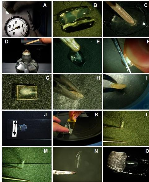
**Figura 7.** Ilustraci3n del m3todo SGEM, para la preparaci3n de secciones de otolitos para el an3lisis de Micro-incrementos. **A:** Aplicaci3n de cera termopl3stico; **BC:** Mezcla de componentes de resina ep3xica; **D& E:** Montaje del otolito; **FJ:** Creaci3n del bloque; **HJK:** Pulido de la secci3n; **LMNO:** Montaje de la secci3n (Fuente: Plaza *et al.* 2005).
