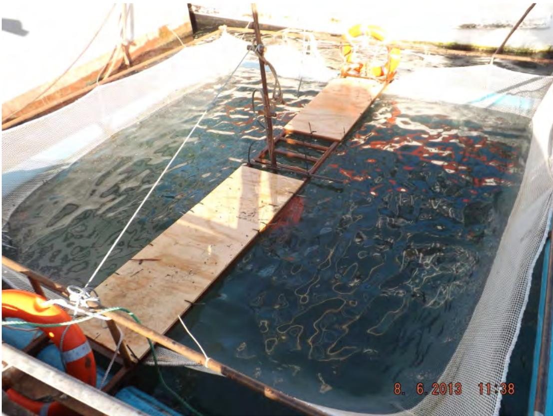
Figura 3.10: Plataforma experimental construida para obtener la fuerza de blanco de sardina austral.
