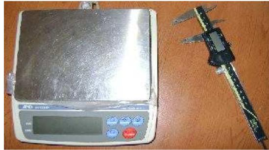
**Figura 16:** Balanza analítica y pié de metro, ambos digitales.
