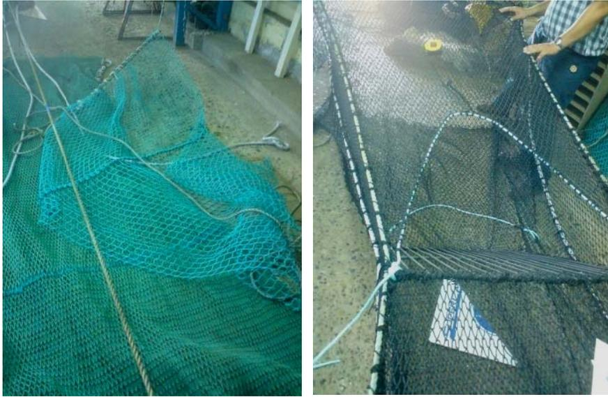
Figura 6. Panel de selección de malla cuadrada (izq) y sección intercambiable con grilla de selección (der.) contruidos para la red.
