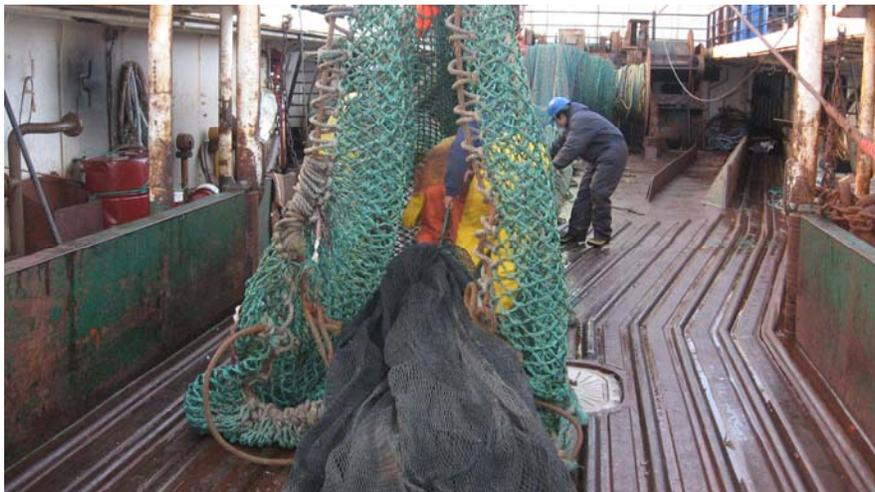
**Figura 3.** Instalaci3n cubrecopo 50 mm en red de mediagua
