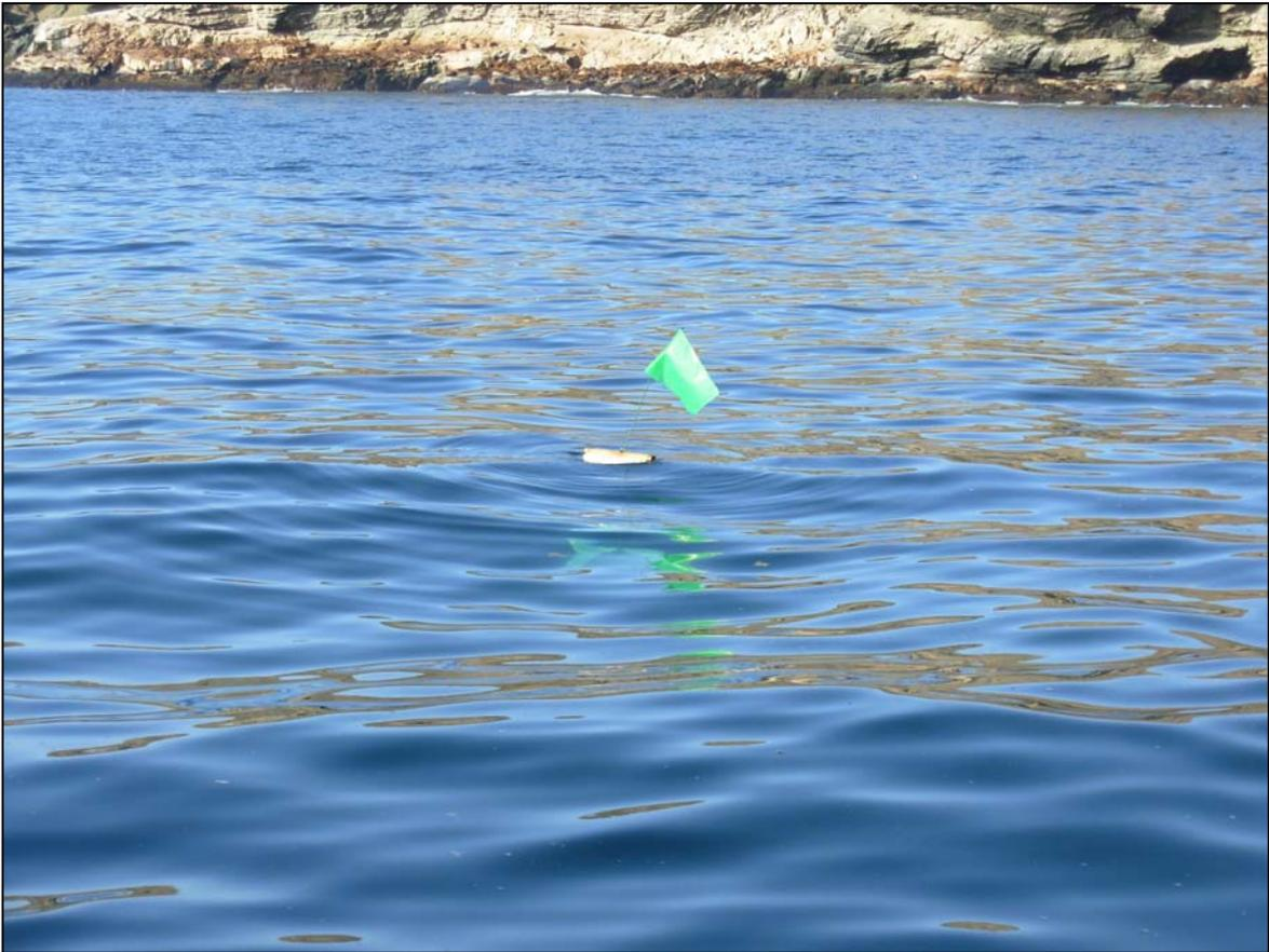
**Imagen 6.** Derivador con una cruceta metálica ubicada a 2 m de profundidad, un flotador y una bandera (verde) superficial para su detección. Dos derivadores similares fueron lanzados cerca de Isla Chañaral.
