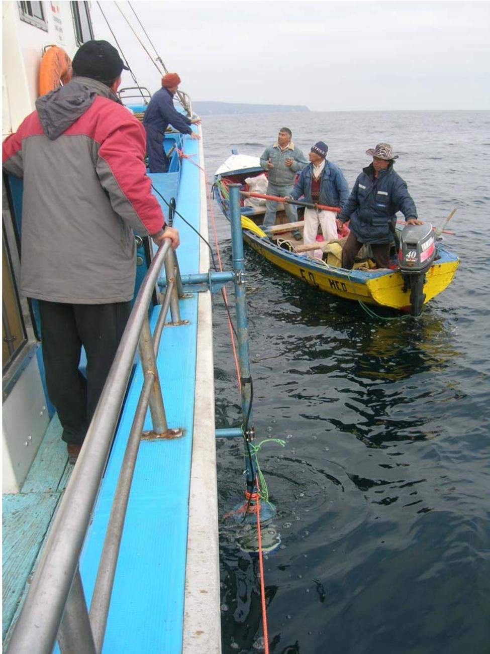
**Imagen 7:** ADCP montado al costado de la embarcación para realizar transectas de los perfiles de corrientes.
