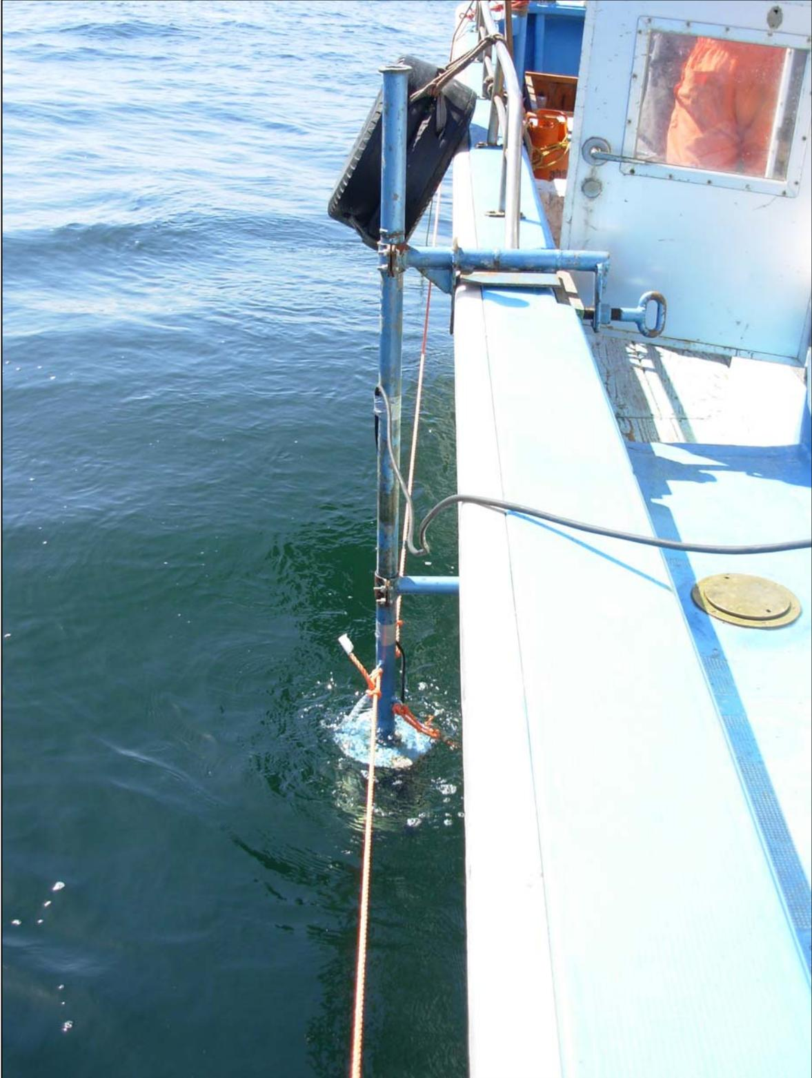
**Imagen 2.** Instalación del ADCP en la banda de la embarcación durante las mediciones de ambas campañas.
