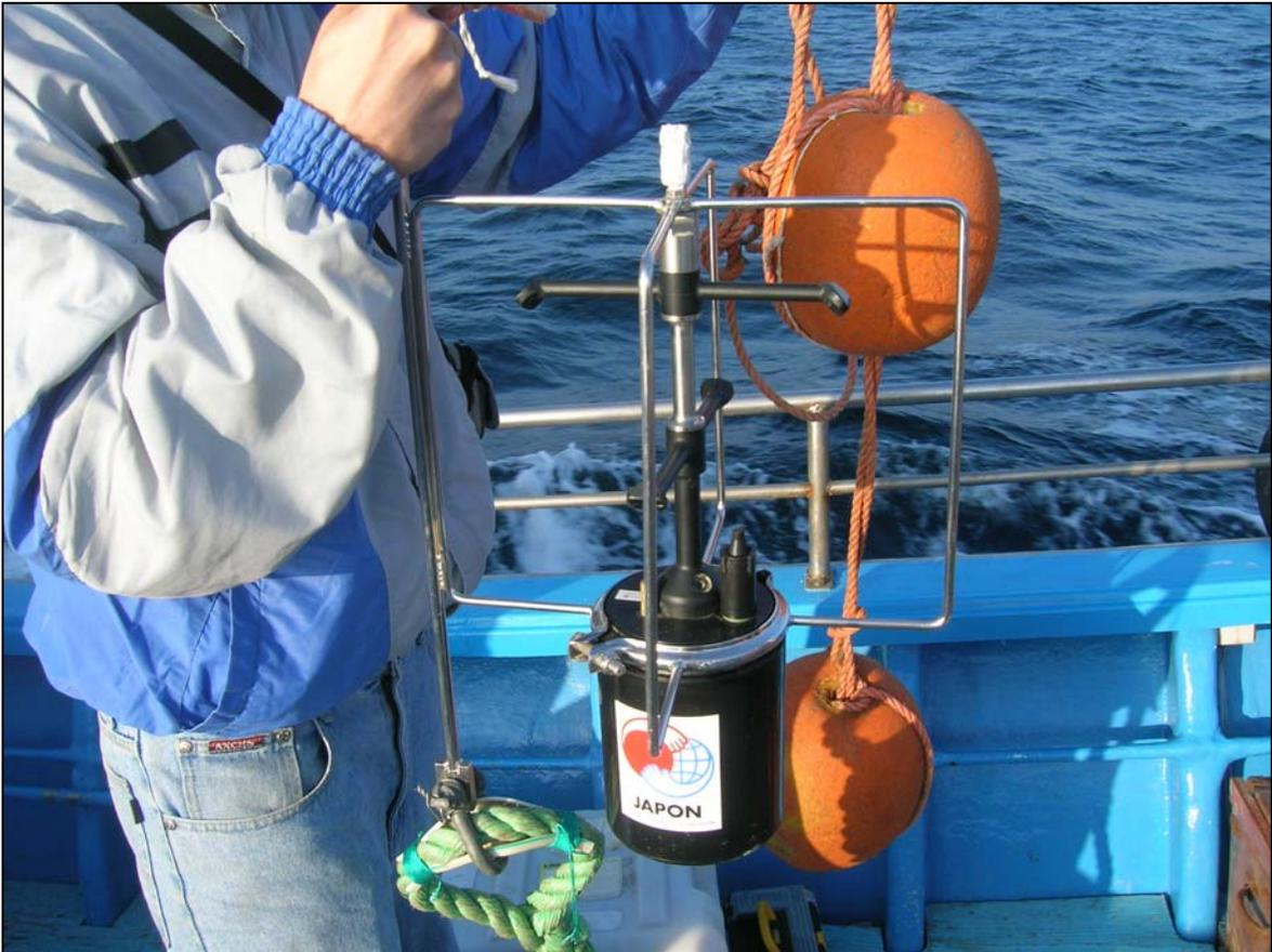
**Imagen 5.** Correntómetro Acústico (ACM) utilizado en las mediciones de corriente frente a Isla Chañaral durante ambas campañas.
