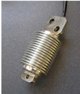
Figura 6. Sensor de esfuerzo.
