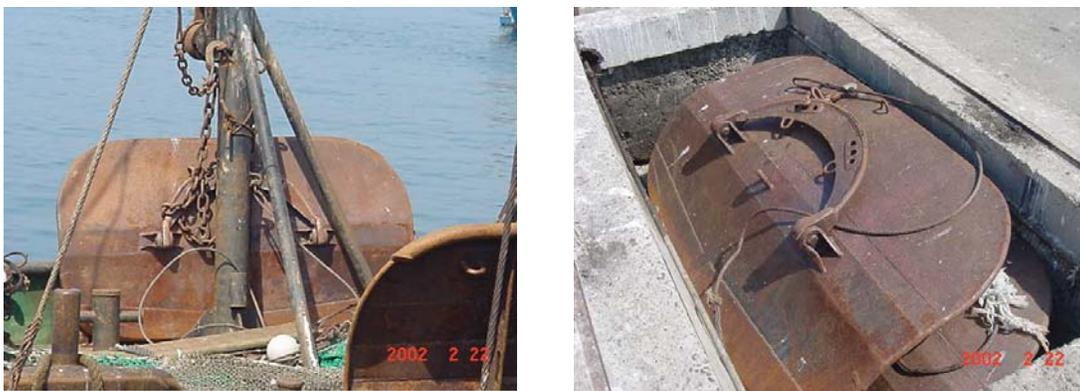
Figura 13. Modelos de portales rectangulares planos y rectangulares en V.
