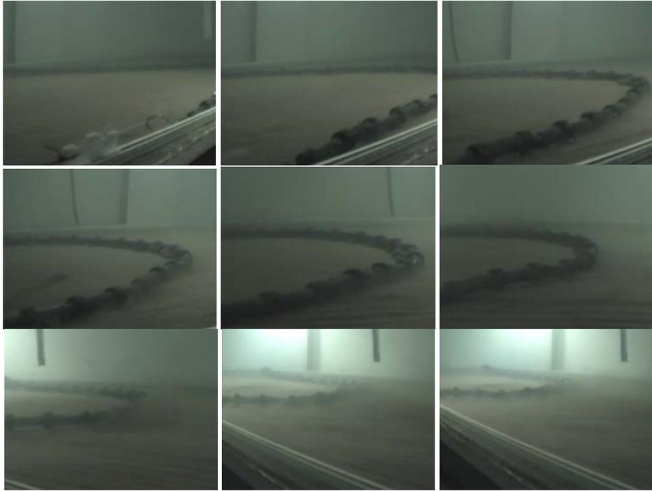
Figura 24. Secuencia de filmación del borlón de caucho, vista lateral.
