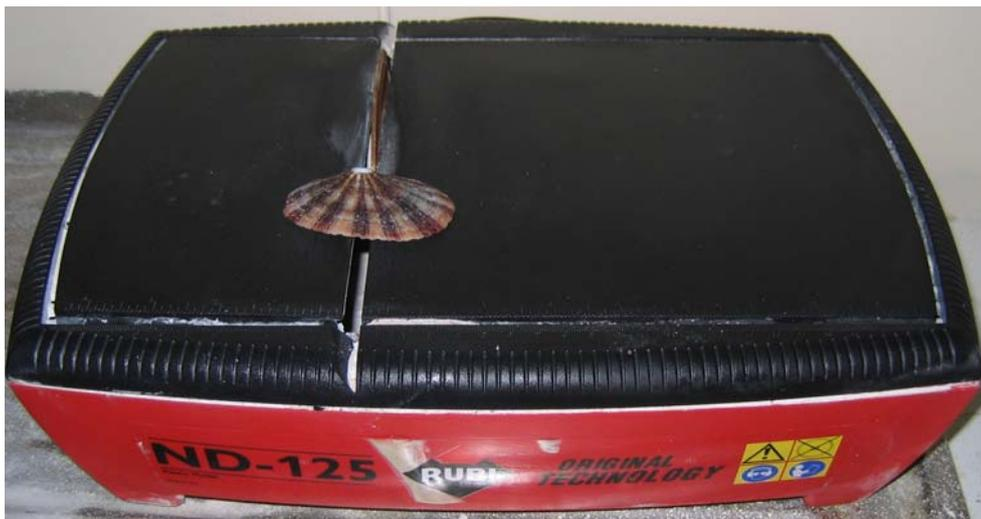
Figura 2.2.2. Maquina utilizada para cortar las conchas de lapa.
