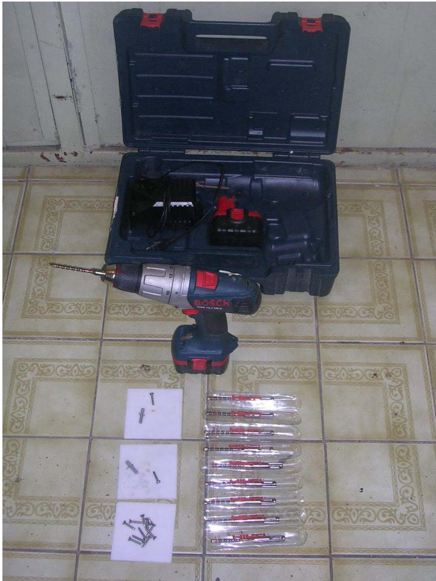
Figura 3.3.23. Material seleccionado para el trabajo en terreno, consistente en; taladro; brocas punta de diamante; placas de acrílico con cinta antideslizante y tornillos de acero inoxidable.
