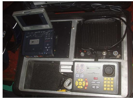
Figura 3.2. a) VRS y cable guía. b) Consola de mandos y sistema de grabación en cinta digital.
