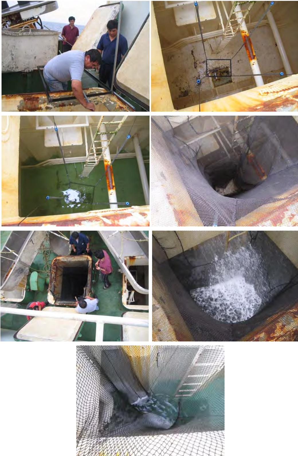
Figura 8. Preparación de la bodega de la nave para la mantención de ejemplares vivos.
