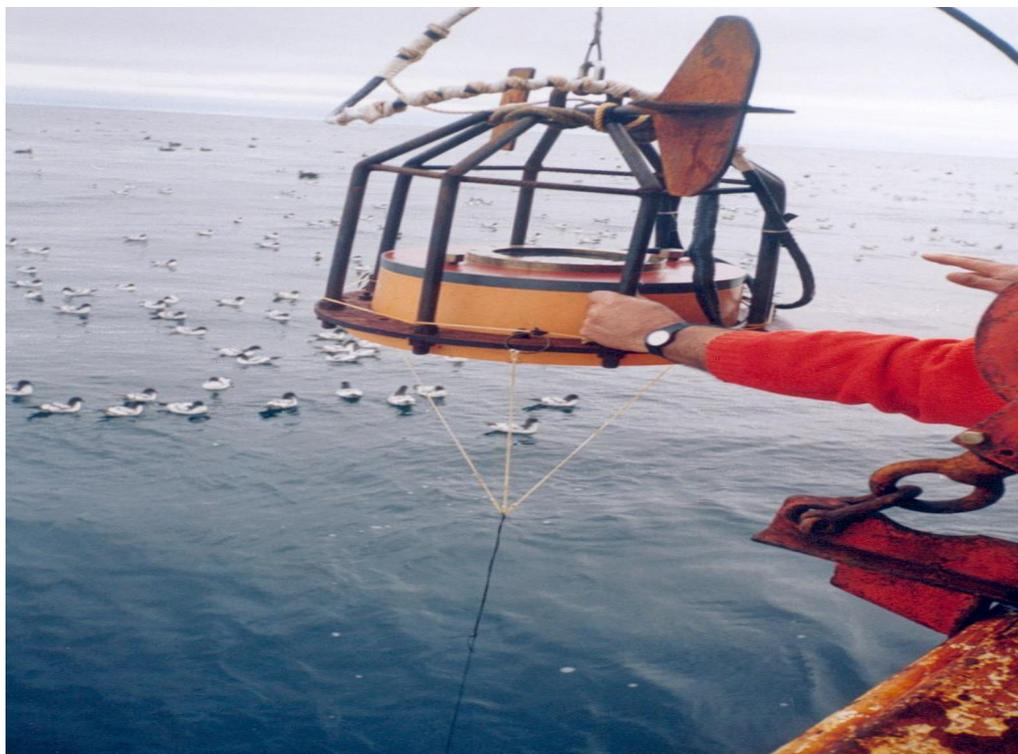
Figura 7. Transductor ES38DD en su armazón.
