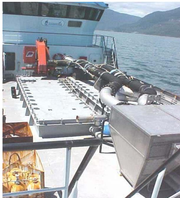
**Fig 4: Estanque derecho de carga para el transporte de biomasa de la embarcación de la Empresa 1**
