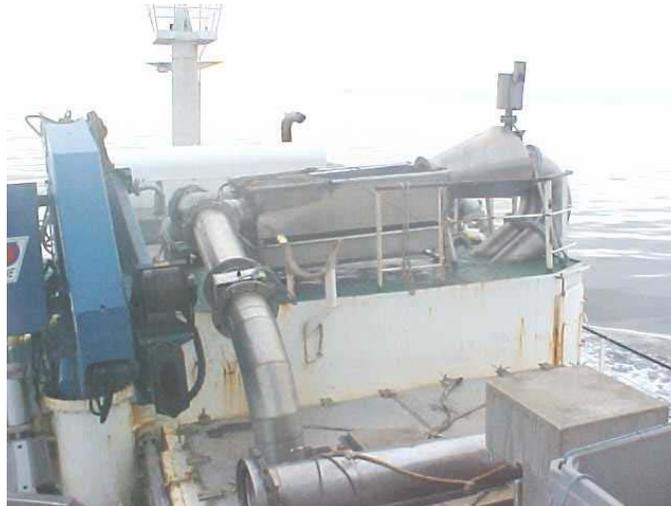
***Fig 7: Estanque de carga para el transporte de biomasa de la embarcación de la Empresa 2***
