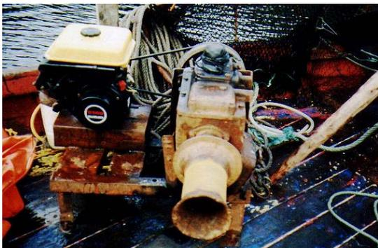
Foto 17. Detalle de "burro" (virador hechizo), utilizado para el virado de trampas.
