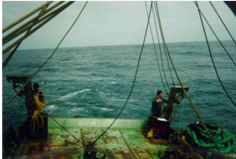
Medición de la distancia de cables entre las pastecas para la determinación de la abertura de punta de alas (APA), mediante método Koyama.
