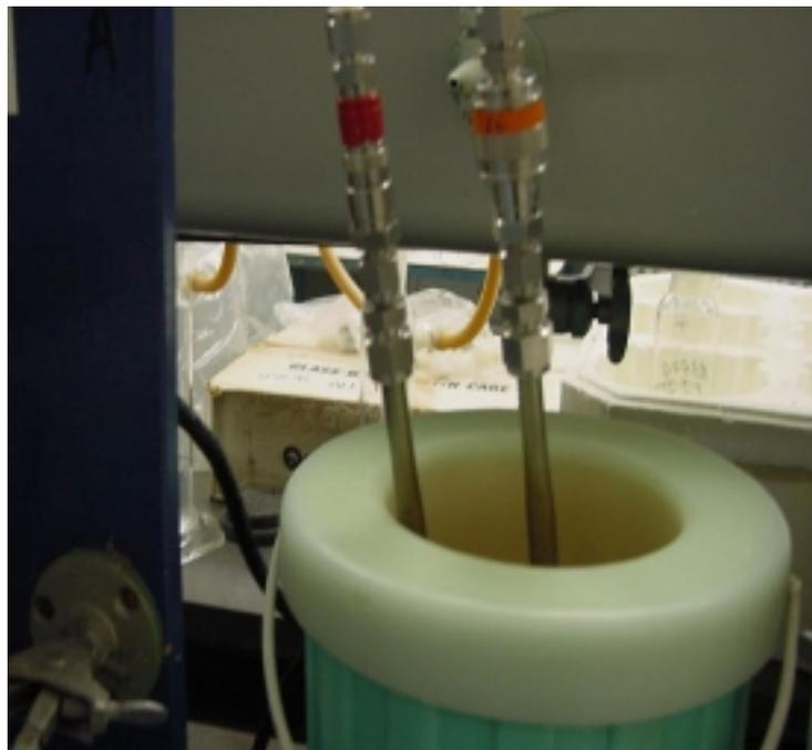
**Figura 61.** Trampas de carbono activado para retener  $^{222}\text{Rn}$  en frío.
