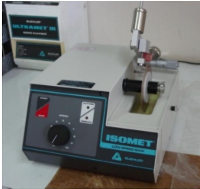
**Figura 33.** Cortadora marca Buehler modelo Isomet, permite obtener corte de los otolitos y secciones delgadas.
