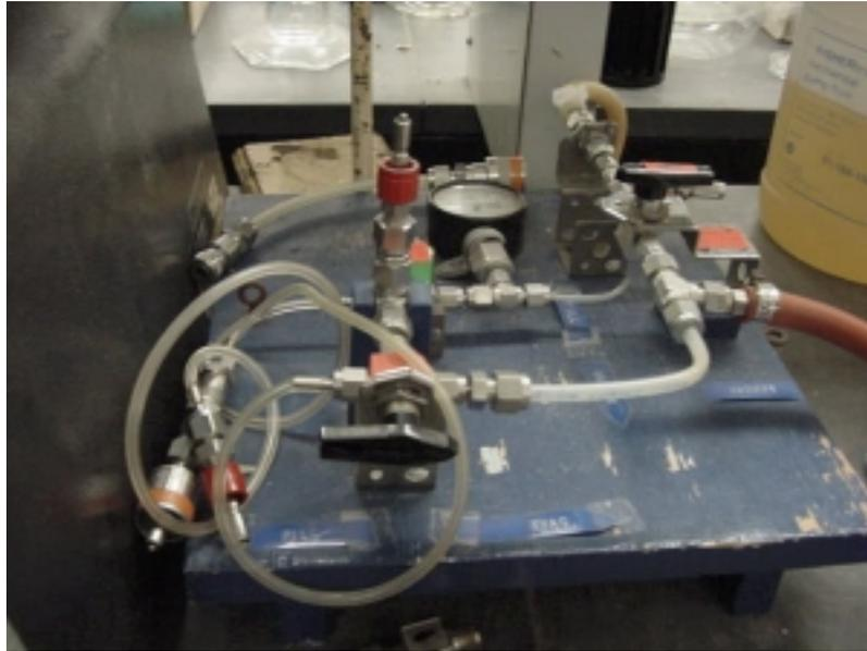
**Figura 60.** Estación de transferencia  $^{222}\text{Rn}$  a celdas de conteo.
