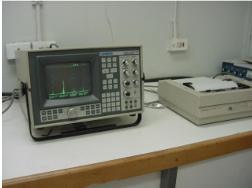
**Figura 58.** Analizador Multicanal utilizado en el conteo de  $^{210}\text{Pb}$ .
