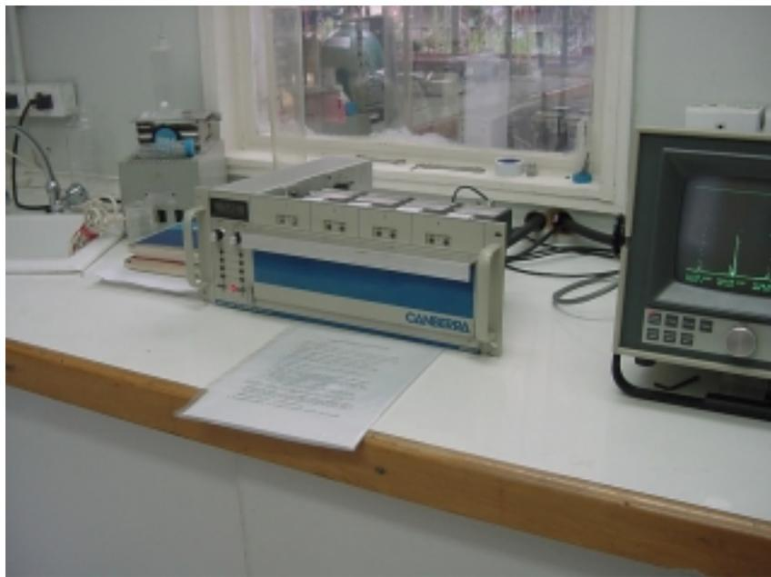
**Figura 59.** Espectrómetro Alpha utilizado para la cuantificación de  $^{210}\text{Pb}$ .
