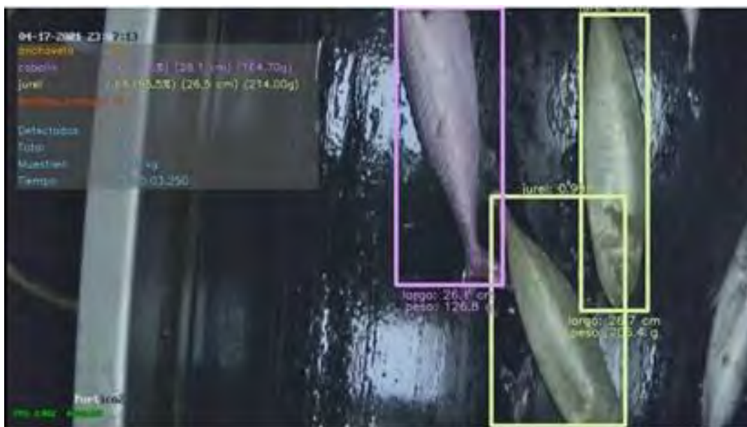
Figura 2. Ejemplo de un sistema detectando caballa y jurel. Se observa que la cámara está ubicada en una posición perpendicular a la correa. El rectángulo alrededor de la especie es conocido como bounding box (Caro et al. 2023).
