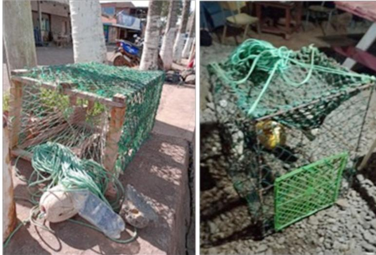
Figura 32 Trampas para capturar Ura (langosta), a) construcción en madera y b) de armazón de acero.
