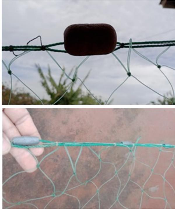
Figura 29 Detalle de la relinga superior e inferior de una red Tuku.
