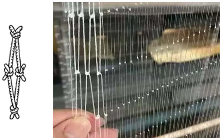
Figura 5. Imágenes de referencia del tamaño de una malla, correspondiente a medida entre nudos de una malla estirada.
