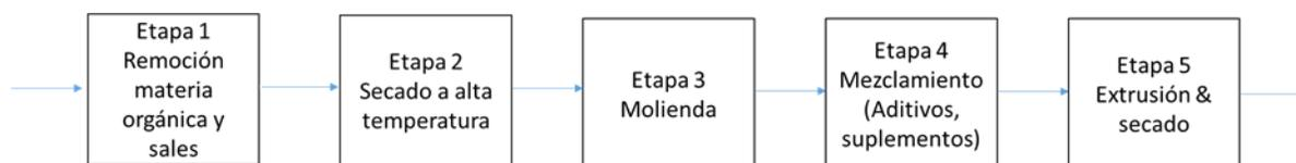
Figura 10. Línea de proceso para la producción de un suplemento de calcio para aves (Patente KR102033222B1).
