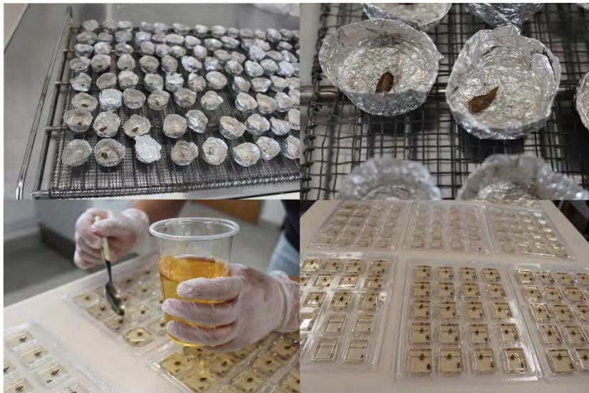
**Figura 17.** Confecci3n de bloques de resina ep3xica con los otolitos tostados de *Trachurus murphyi*. Cada bloque de resina est1 etiquetado con el ID del otolito y una l3nea transversal en el bloque que gu3a la direcci3n y lugar del corte.
