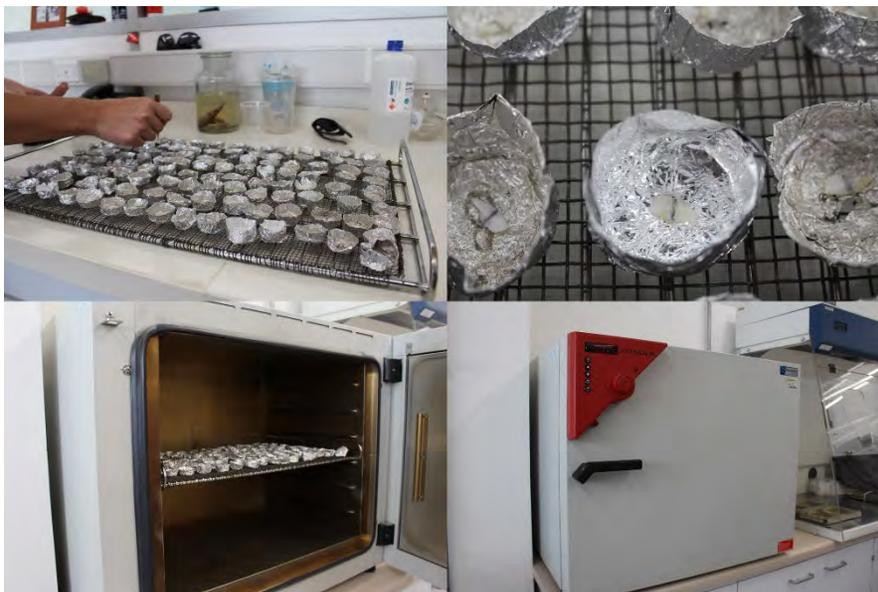
**Figura 16.** Procedimiento de tostado de otolitos de *Trachurus murphyi*. Los otolitos son depositados cuidadosamente en recipientes de aluminio y horneados en una estufa de secado Binder ED-115 durante 10 minutos a 300°C.
