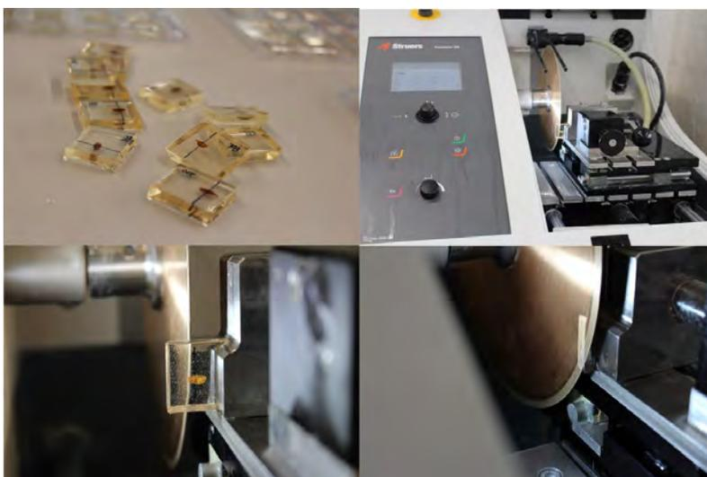
**Figura 18.** Procedimiento de corte de los bloques de resina ep3xica para obtener la secci3n de otolito.
