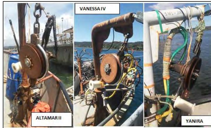
Figura 10. Chigres o platos viradores de cabo, usados por la flota artesanal de Chiloé para operar redes de enmalle.
