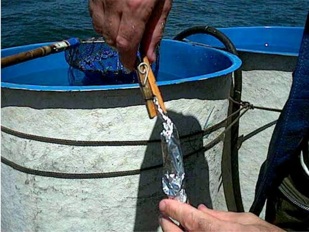
Figura 3.- Sujeci3n del pez para sumergirlo en nitr3geno l3quido.
