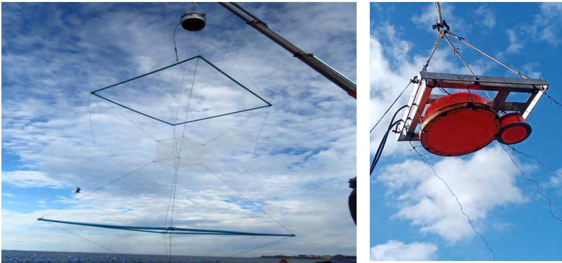
Figura 9. Arreglo del sistema de la jaula cúbica de 0,5x0,5x0,5 m y de los transductores de 38 y 120 khz usado para la calibración de anchoveta con jaula.
