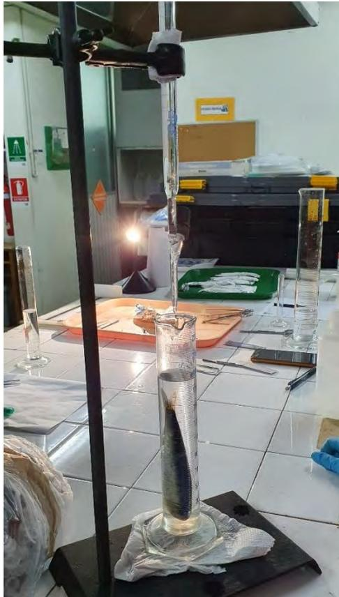
Figura 17.- Obtención de los estimados de volumen en laboratorio mediante el método de volumen desplazado.
