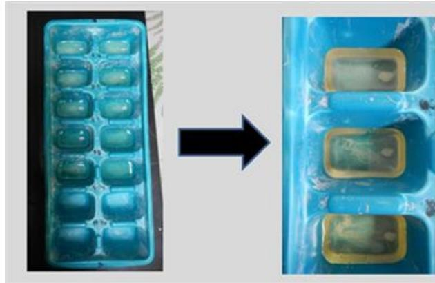
Figura 10. Proceso de montaje del otolito en resina de poliéster en moldes de silicona.
