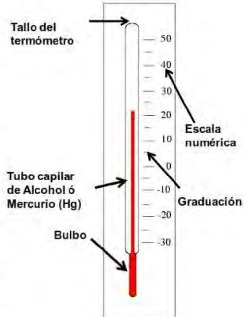
Figura 6. Partes de un termómetro
