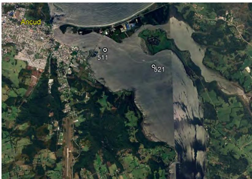
Figura 22. Georeferenciación de la instalación de correntómetros electromecánicos en el Rio Pudeto.
