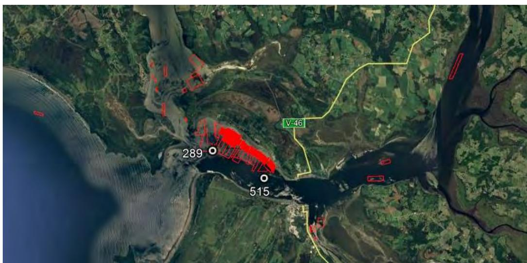
Figura 96. Georeferenciación de la instalación de correntómetros electromecánicos en el Río Maullín.
