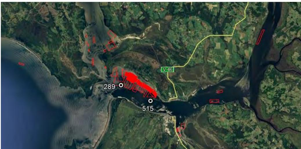
Figura 119. Georeferenciación de la instalación de correntómetros electromecánicos en el Río Maullín (289: Changue-Las Conchillas; 515: El Carrizo).
