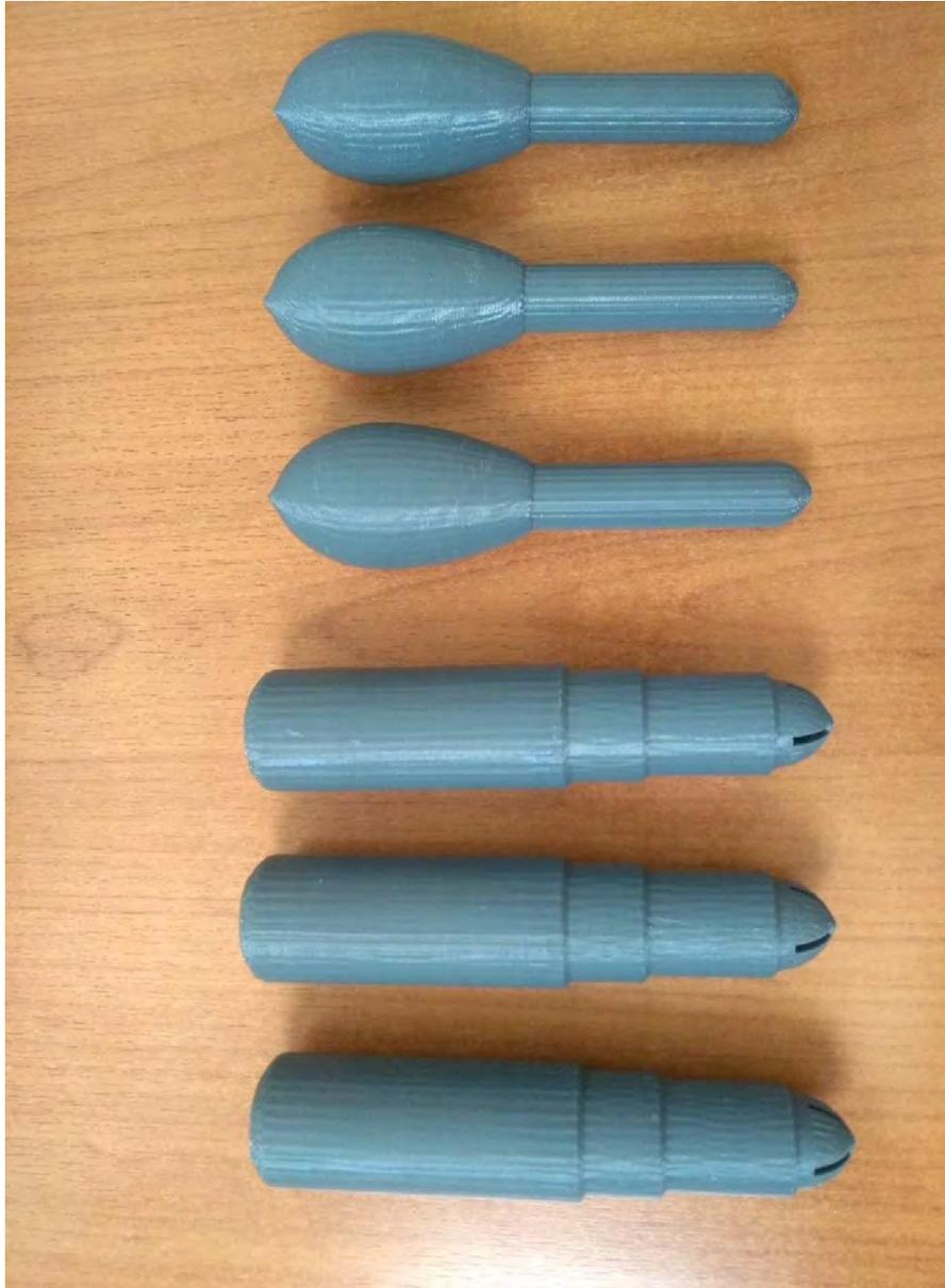
**Figura 17.** Impresiones 3-D para la marca X-TAG (3 superiores) y MrPAT (3 inferiores).
