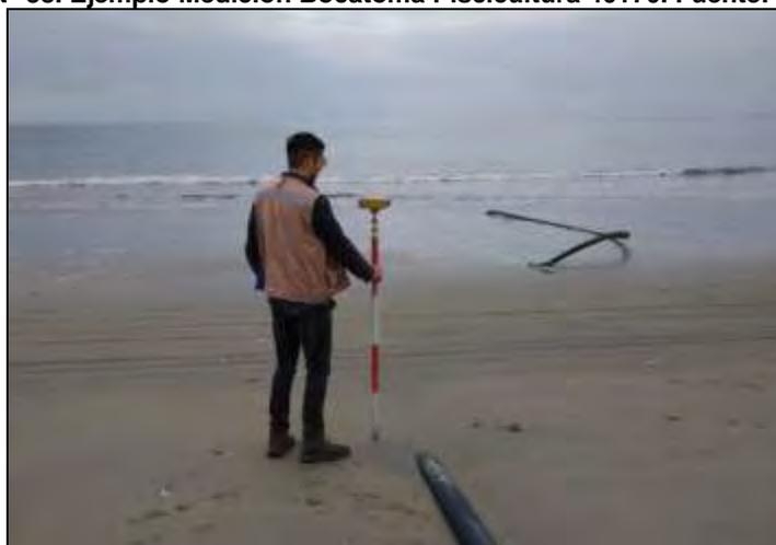
En la siguiente figura se observa al equipo de terreno realizando labores de demarcación de descarga del centro. Dicha medición fue supervisada por personal del centro, los cuales acompañaron en la tarea.
