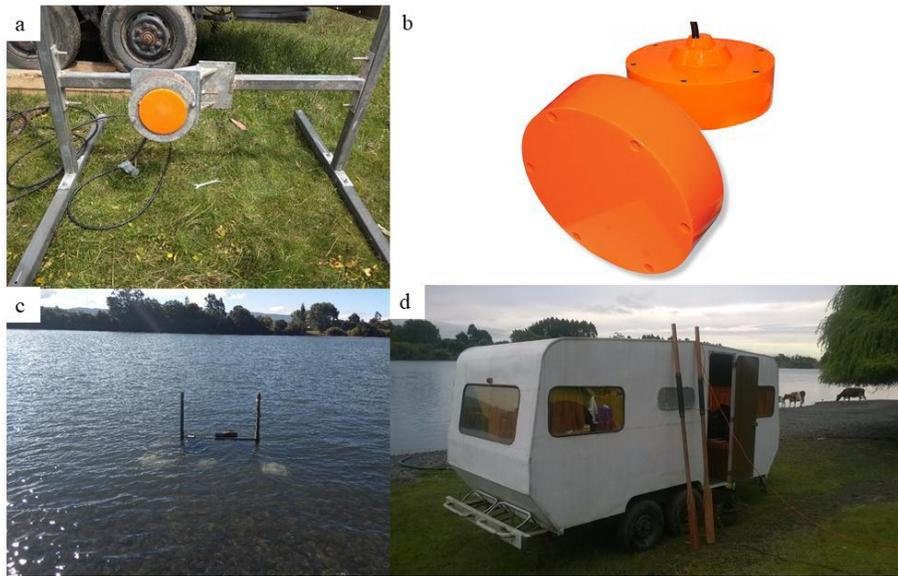
Figura 7. a) Equipo hidroacústico SIMRAD EK-60 de 120 kHz, adosado a estructura metálica de soporte, b) Equipo hidroacústico SIMRAD EK-60 de 38 kHz, c) disposición del equipo respecto al río, d) Estación de monitoreo hidroacústico.
